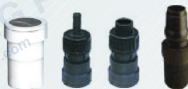
过滤器底阀：能有效解决吸程过高的管路系统，协助计量泵合理工作，并设有过滤网目，去除管路中的杂质。又名：底阀。 常用材质：PVC、304、316、PTFE 常用口径：DN10 DN15 DN25 DN32 DN40
